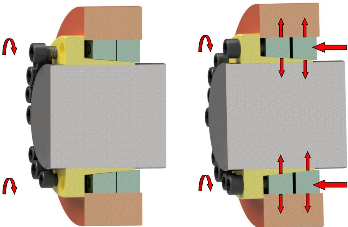
Der Spannsatz ist wartungsfrei und die Schrauben müssen nicht nach einer bestimmten Betriebszeit nachgezogen werden.
